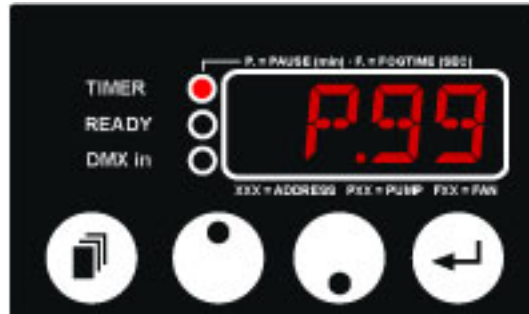
Abbildung 5: Einstellen der Pausenzeit in Minuten (0,1 - 99)
