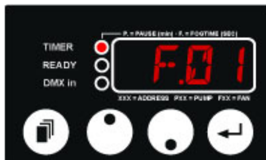
Abbildung 6: Einstellen der Nebelzeit in Sekunden (1 - 99)
